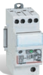
Parafoudre T2 + T3 In 10 kA, I max 12 kA/pôle avec cassette débrochable et voyant d'état à LED
